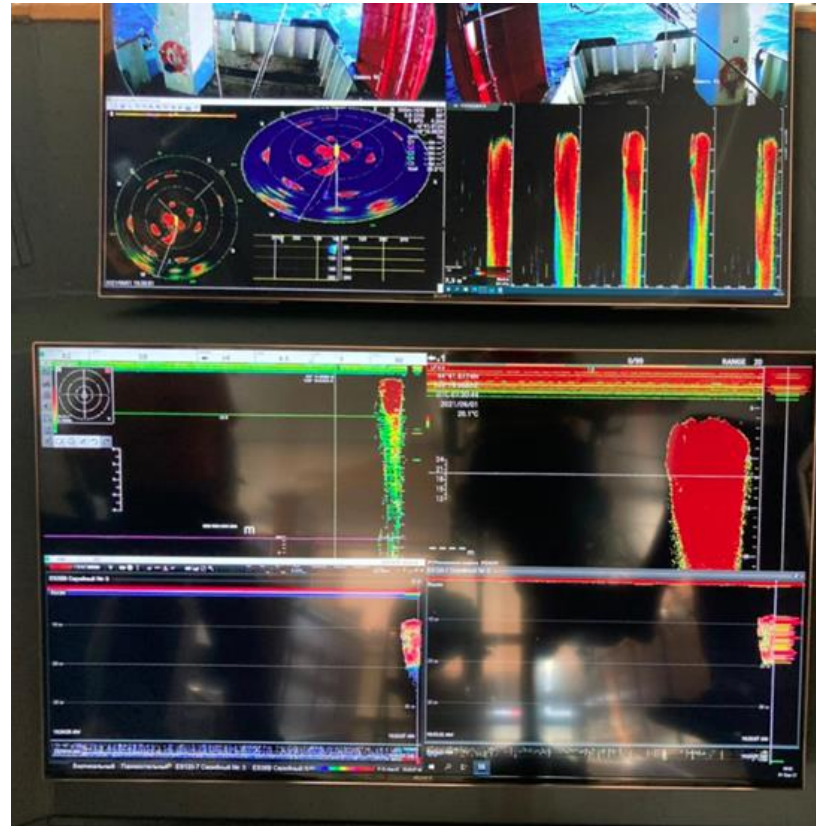
Система контроля трала (гидролокатор, видеокамеры кормовые) МРКТ «Сергей Бочкарев» компании Сигма Марин Технолоджи
